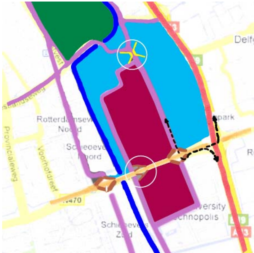
Figuur 7: ontmoedigen verkeer vanuit noorden, ontsluiting Rotterdamse weg, extra opstelcapaciteit en bypasses naar A13
